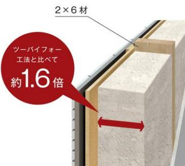
ツーバイフォー工法に比べて、約1.6倍も骨太な38mm×140mmの2×6材を外壁の枠組みに使用。断熱材の使用量も約1.6倍となり、夏涼しくて冬暖かい住まいを実現します。
